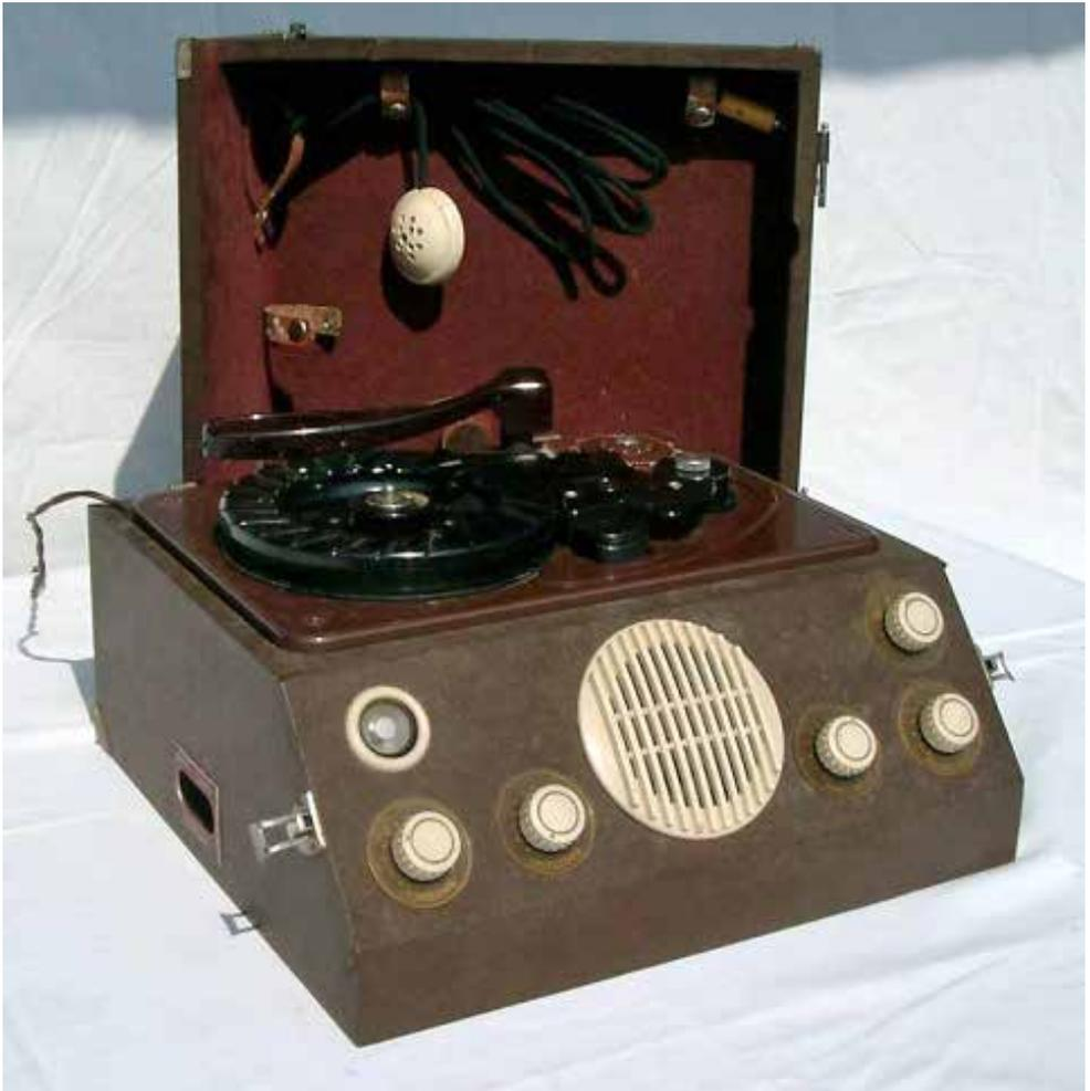
*Das Drahttongerät des Instituts, hier mit aufgelegtem Teller für Schellackplatten.*
